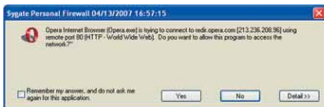
Bildschirmdialog einer Personal Firewall: Erst nach Erlaubnis des Benutzers darf das Programm (ein WWW-Browser) auf die Webseite im Internet zugreifen
